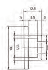
Perfil Alumínio 30x3 - P1.502303 Para o Perfil PE.40x1 - B7.367001 (Verde) - B7.367040 (Branco)
